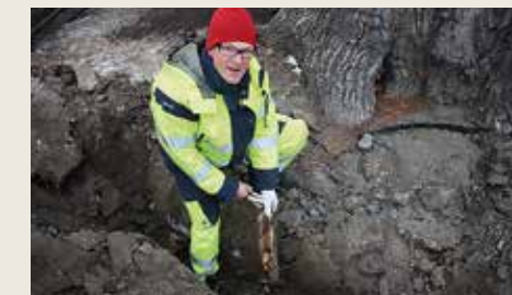
Provgrävning vid ek på Fiskartorpsvägen – rötangripna och döda grova rötter upptäcktes på 60-70 cm djup.
