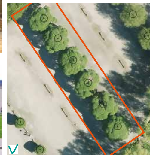
Fig. 1. Staket placeras i träden dropplinje. Inga upplag får förekomma innanför staket. Ingen trafik eller maskiner får röra sig innanför staketet.
